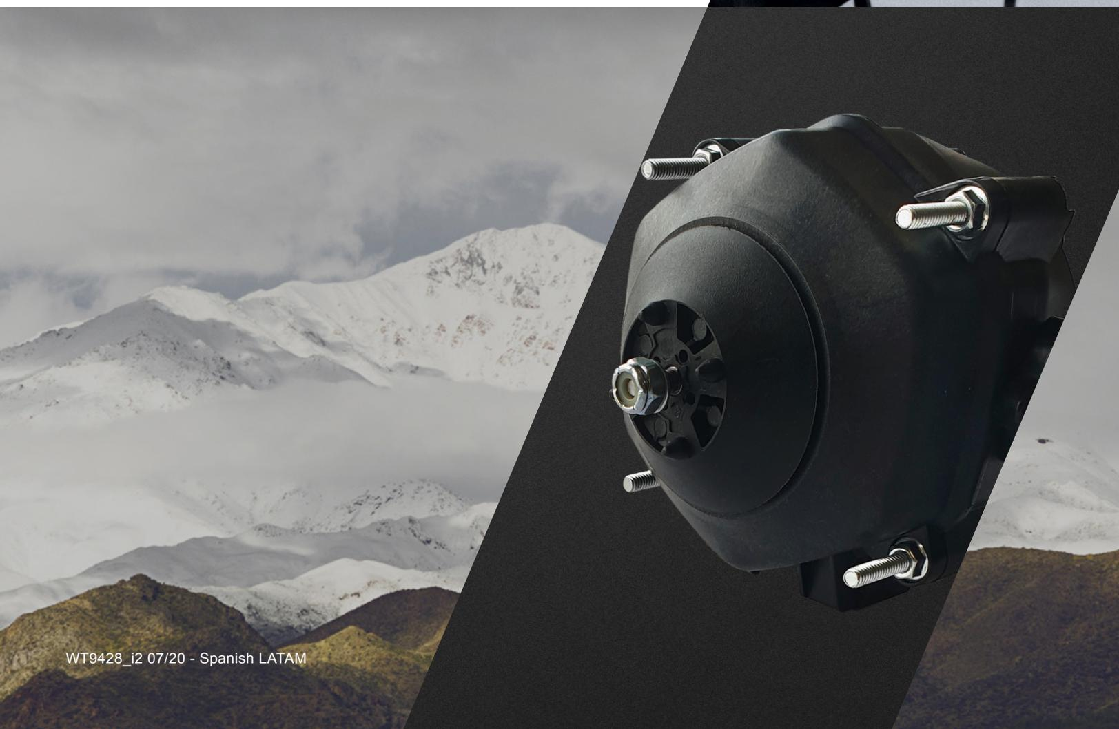
Los motores Wellington **ECR® 2** de AoFrio reducen el consumo de energía y las pérdidas térmicas en refrigeradores de bebidas y máquinas expendedoras al cambiar el ventilador a baja velocidad cuando el compresor no está funcionando. Esto se hace conectando el cable de control del motor (cable negro) directamente al circuito del compresor. Esto elimina la necesidad y el gasto de un controlador de sistema con salidas de control de ventiladores.
