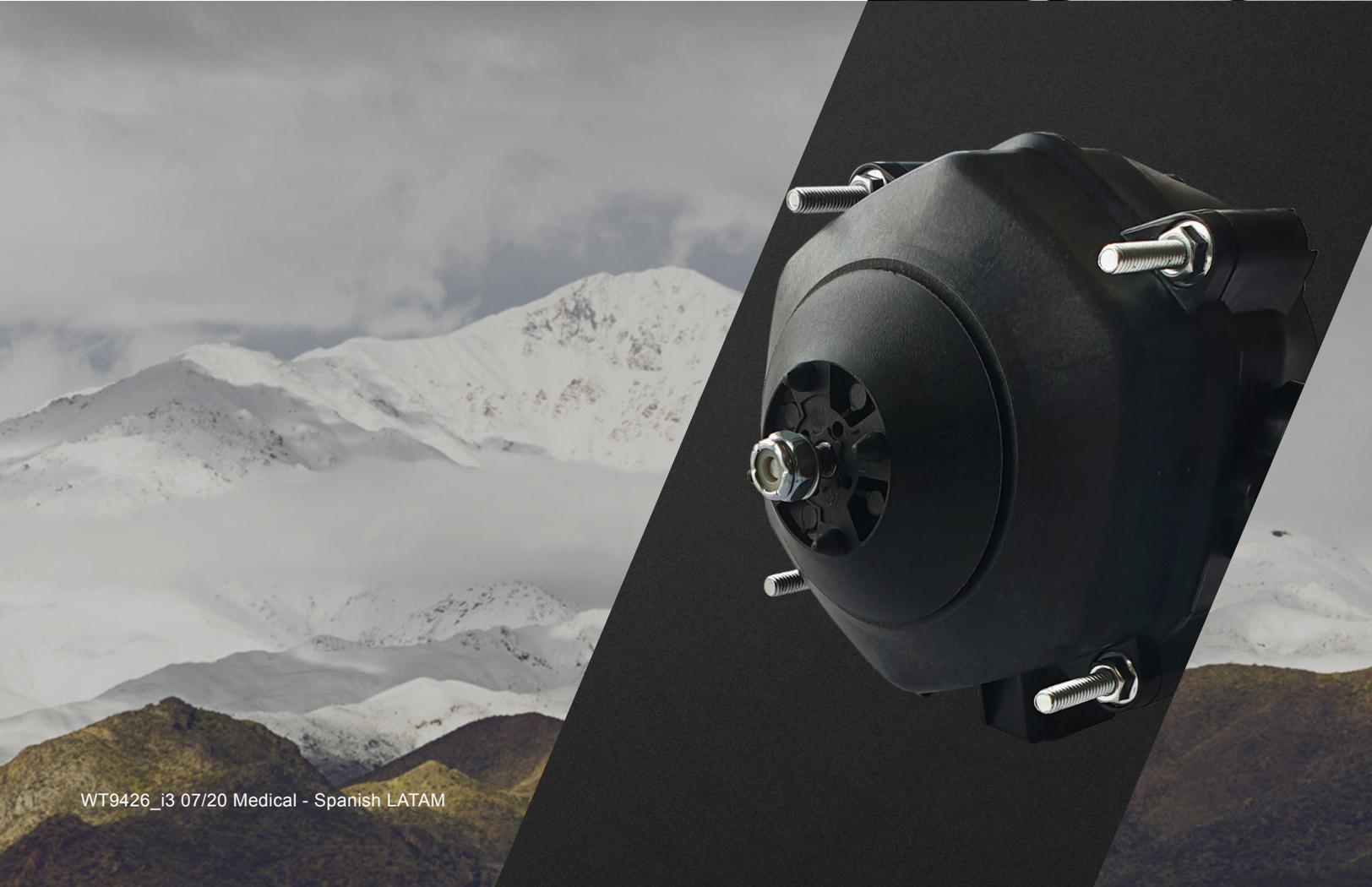
Los motores de tres velocidades, como el motor Wellington **ECR® 2** de AoFrio, reducen el consumo de energía y las pérdidas térmicas en equipos de conservación de frío. En casos de refrigeradores de puertas cerradas, esto se logra cambiando el ventilador a una velocidad menor cuando el evaporador no está en un ciclo de enfriamiento.
