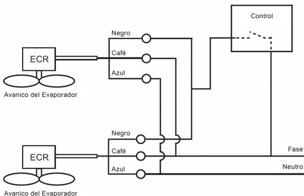
El motor ECR 2 de tres velocidades en vitrina con controlador. El controlador debe programarse con la función "ventilador apagado" para cuando no esté en ciclo de enfriamiento, con lo que el motor funcionará a una velocidad mínima.
