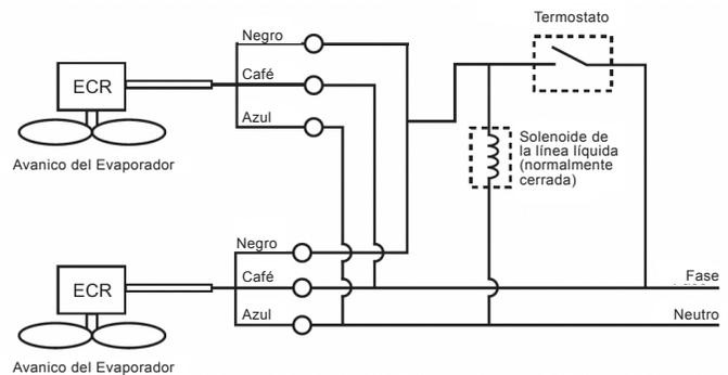
El motor de tres velocidades ECR 2 en una vitrina sin controlador. La velocidad del ventilador se controla conectando el cable de control negro en la válvula solenoide de la línea de líquido (si cuenta con interruptor eléctrico) o en la salida del motor del ventilador del gabinete.
