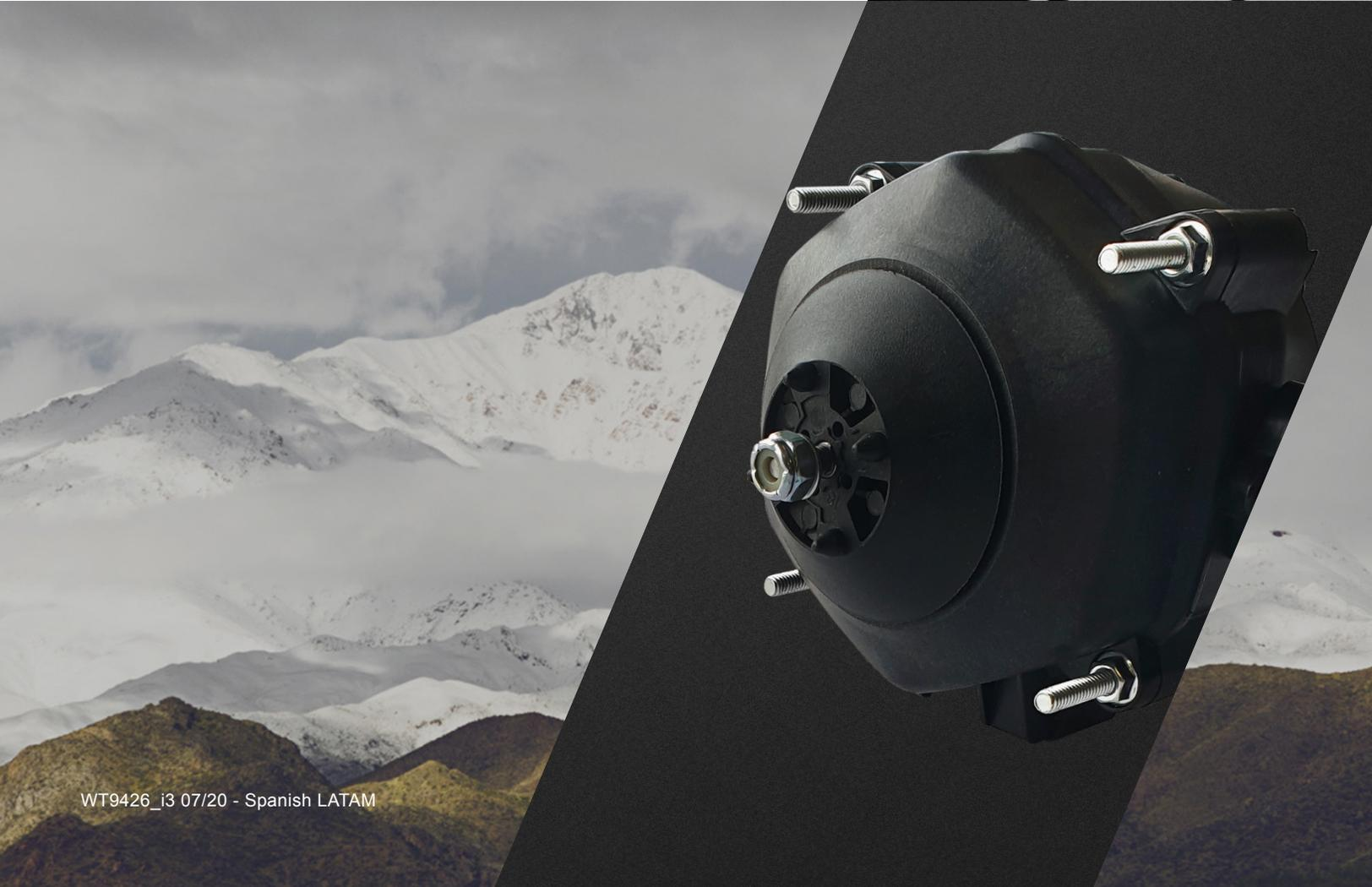
Los motores de tres velocidades, como el motor Wellington **ECR® 2** de AoFrio, reducen el consumo de energía y las pérdidas térmicas en las vitrinas. En casos de puertas cerradas, esto se logra cambiando el ventilador a una velocidad más baja cuando el evaporador no está en un ciclo de enfriamiento.
