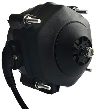
El motor ECR 2 es electrónicamente conmutado (ECM), que acepta tensión de alimentación de 70 a 264V. Puede ser programado desde fábrica a tres velocidades discretas ajustadas desde 300 hasta 1800 RPM, en cualquier dirección o con operación por tiempo.
