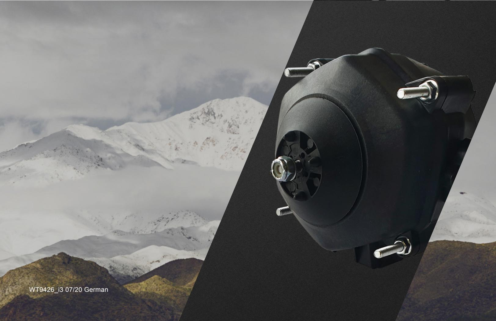
Motoren mit drei Drehzahlen, wie der **Wellington™ ECR 2**, reduzieren den Stromverbrauch und Wärmeverlust in Vitrinen. In Vitrinen mit geschlossener Tür wird dies erreicht, durch den Lüfter auf eine niedrigere Drehzahl zu schalten, wenn der Verdampfer sich nicht in einem Kühlzyklus befindet.
