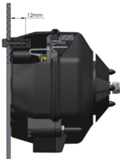
Figura 4. – Tornillo de montaje trasero
